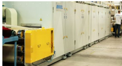
Línea de unión de paso de aire de ANDRITZ en las instalaciones del CETI (Centro Europeo para Textiles Innovadores) en Lille, Francia © 2018 ANDRITZ
