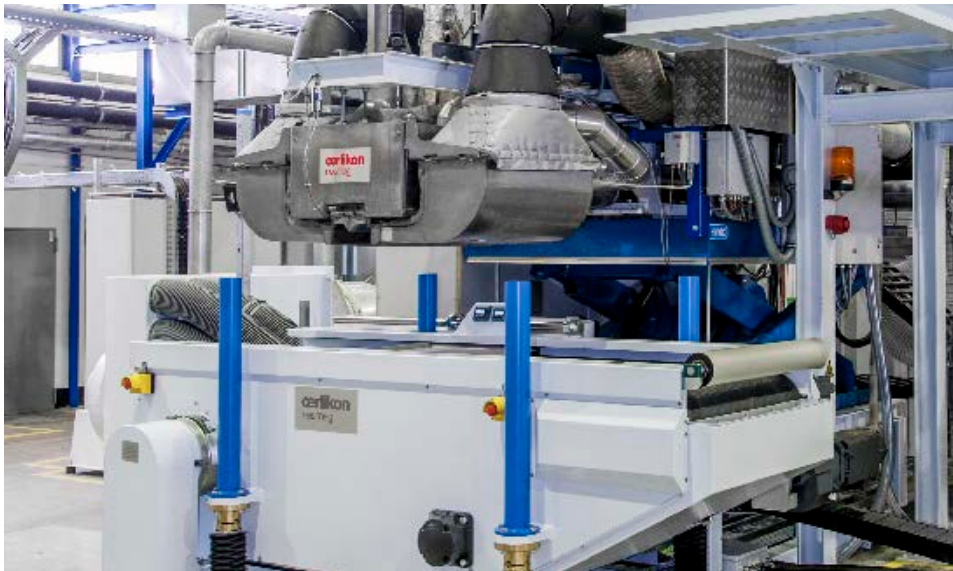
Oerlikon Neumag 用于熔喷系统的多功能成型台，大幅降低了环境足迹并缩短了线长，从而降低维护成本。(c) 2017 Oerlikon
