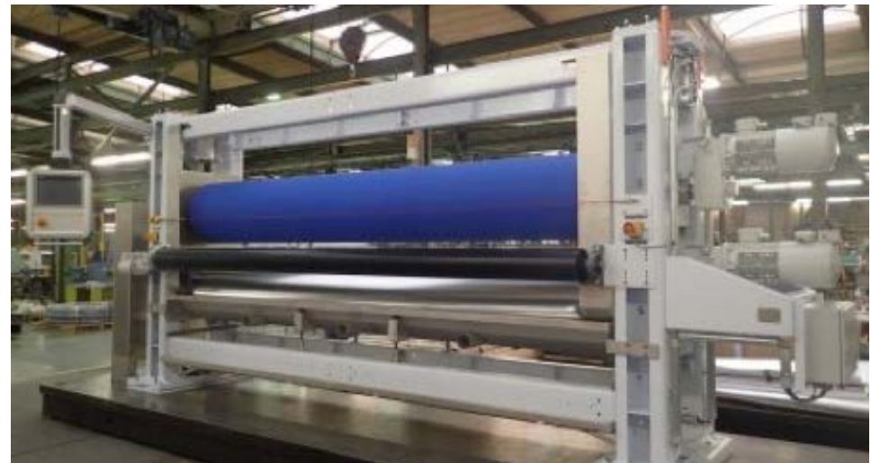
用于粘合剂粘合纤网的高速上浆机
