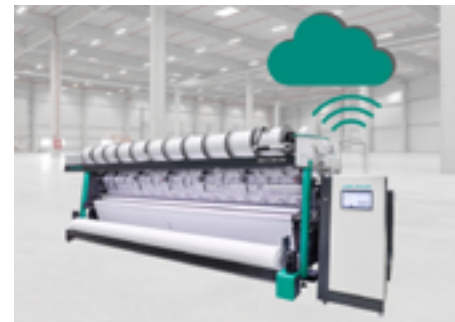
Ein Vertreter der HKS 3-M ON, die die Daten für die Musterung direkt aus einer Cloud lädt © 2021 KARL MAYER
