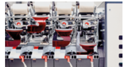
Ausgestattet mit SynchroPiecing kann jede AutoBD-Rotorspinnmaschine bis zu 1 500 Anspinnungen pro Stunde vollautomatisch abwickeln, so dass kaum eine Abhängigkeit von der Personalverfügbarkeit besteht © 2021 Saurer
