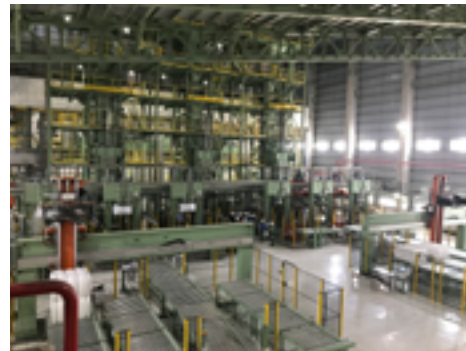
Autefa Solutions UNI-FORK System mit 3 Vorpressen und 6 Hauptpressen © 2021 Autefa Solutions
