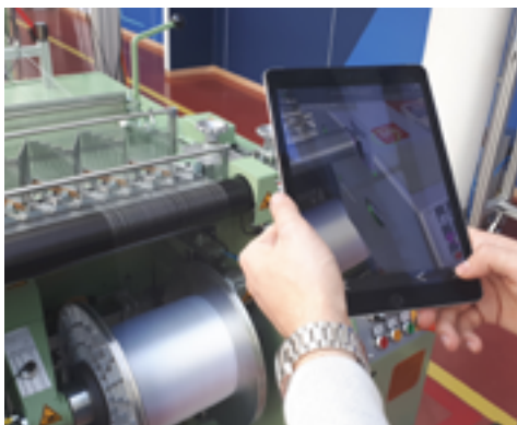
Abbildung 2: Augmented Reality-basiertes Assistenzsystem zur Wartung und Instandhaltung von Textilmaschinen im Schaufenster Aachen © ITA
