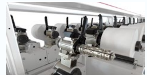
Online-Gegendruck- und Dichtesteuerung © 2021 SSM
