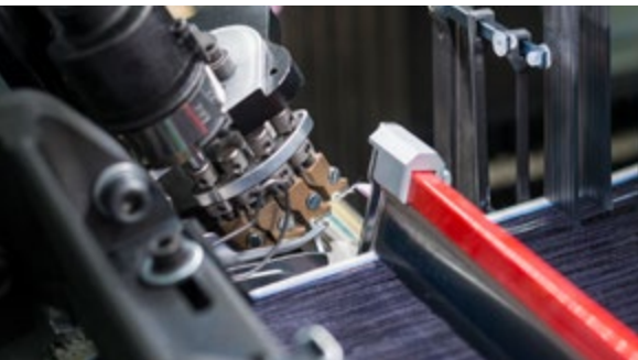
iSAVER® eliminiert die überschüssige Webkante auf der linken Seite des Gewebes, indem er den Schussfaden ohne zusätzliche Fäden einfügt © itema Group
