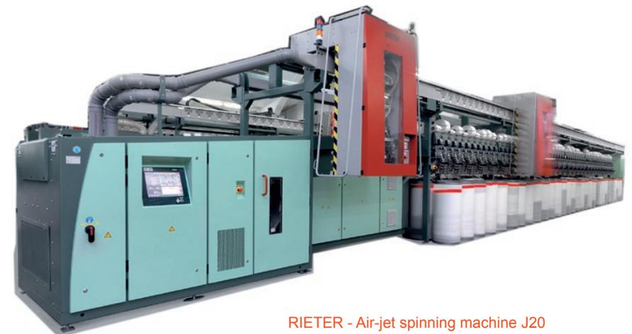
RIETER - Air-jet spinning machine J20
