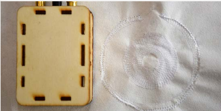
Textiler Lautsprecher: flexibel, leicht und vielfältig in der Anwendung © 2020 Thomas Heinick, SmartTex network
