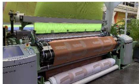
Gesichtsmasken so präzise wie Airbags. Die DORNIER-Systemfamilie eignet sich für die schnelle, einfache und prozesssichere Herstellung von Gesichtsmasken z.B. aus Baumwolle oder Polyester © 2020 DORNIER
