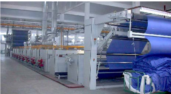
BRÜCKNER Denim Linie mit Spannrahmen © 2020 BRÜCKNER
