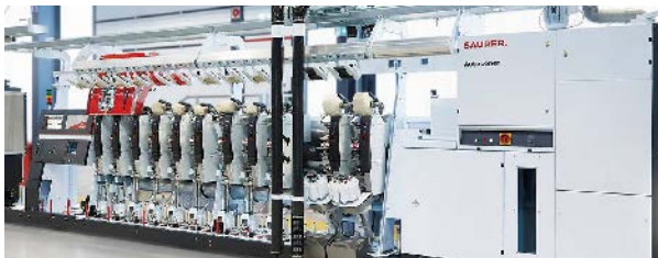
Autoconer: Qualitätsspulen mit FX-Wickeltechnik © 2020 SAURER
