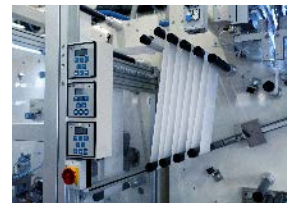
D-TECH Atemschutzmasken-Linie: Spannungskontrollsystem © ANDRITZ
