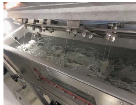
Abb. 3: Prototyp des innovativen Waschsystems in Versuchsspinnanlage am ITA © 2020 ITA
