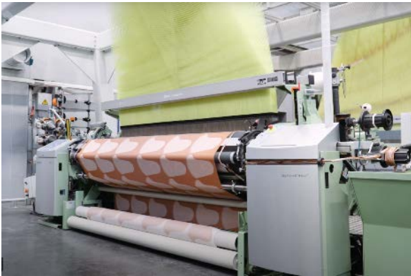
Weben von „One Piece Woven“-Gesichtsmasken auf Luftwebmaschinen des Typs A1 © DORNIER
