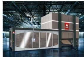
Wasserstrahlverfestigungsmaschine V-Jet FUTURA und der Square Drum Dryer SQ-V © Autefa
