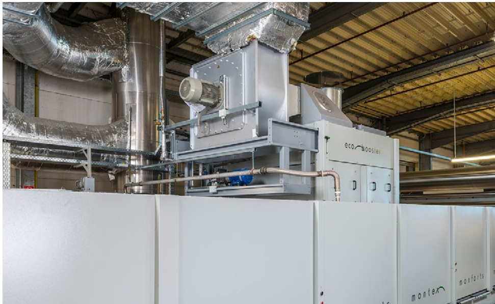
Der Monforts Universal Energy Tower kann den Energieverbrauch einer Linie um bis zu 30 % senken © 2022 Monforts
