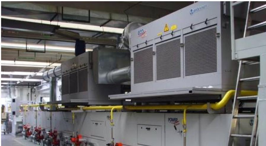
El sistema de recuperación de calor Brückner ECO-HEAT
