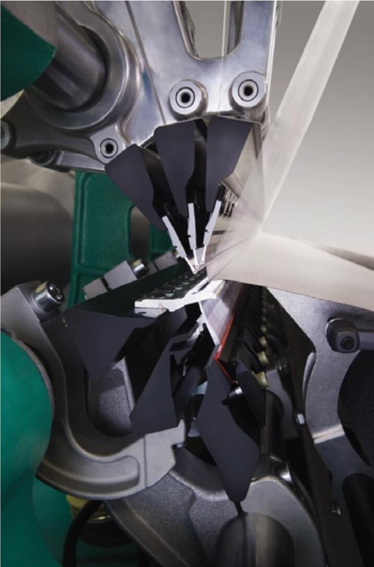
Karl Mayer: Vista en sección transversal de un lugar de tejer con barras de CFRP
