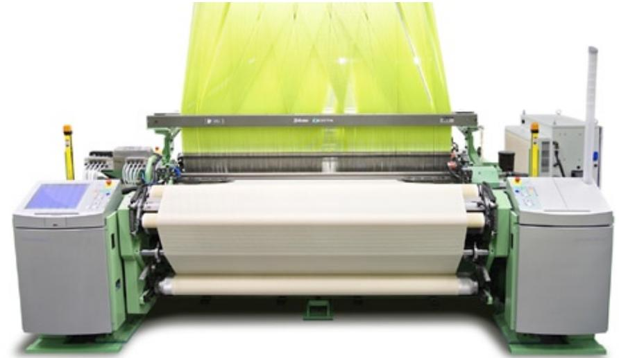
La máquina de tejer de chorro de aire Lindauer DORNIER A1 (Jacquard). El nuevo concepto de transmisión patentado DORNIER SyncroDrive® con motores EFF1 aumenta la velocidad hasta en un 10% con una mínima generación de calor y el mismo requerimiento de energía.
