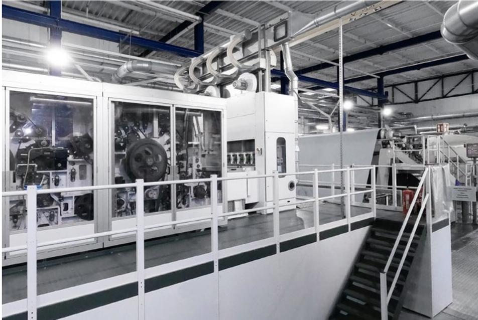
Carded/Pulp (CP) Produktionslinie für biologisch abbaubare Kompositvliesstoffe aus Zellstoff und Viskosefasern
