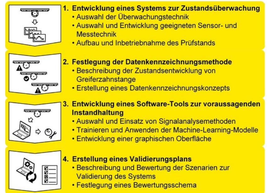
Abbildung 1: Programtablauf der voraussagenden Instandhaltung, Quelle: ITA
