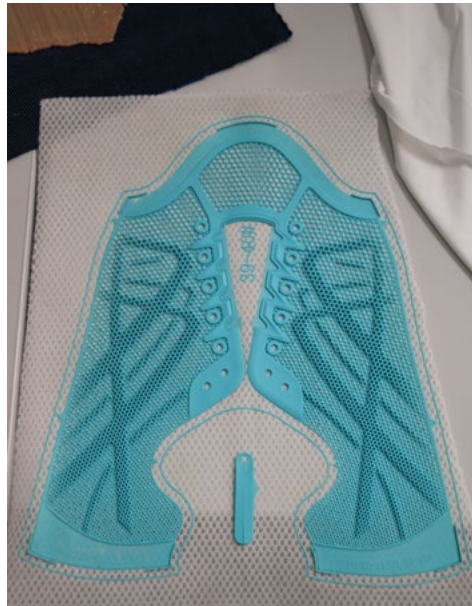
Tejido de punto por urdimbre para calzado con estructura de refuerzo impresa en 3D © 2022 KARL MAYER
