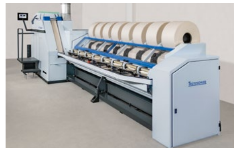
Satisface las exigencias de los hilanderos de algodón de todo el mundo: La nueva peinadora Trützschler TCO 21 © 2022 Truetzschler
