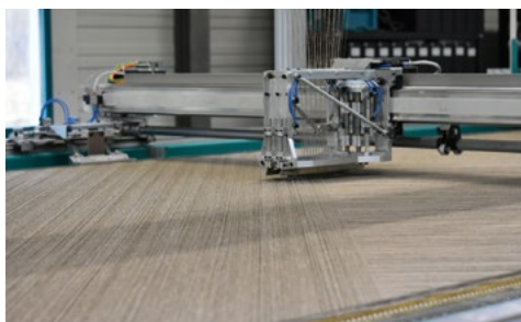
Procesamiento de fibras de lino en una máquina de tejido por urdimbre multiaxial © 2022 KARL MAYER
