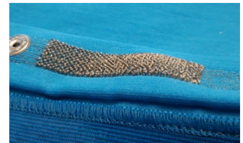
Gewirkte Sensoren mit optimiertem Hautkontakt © 2022 KARL MAYER
