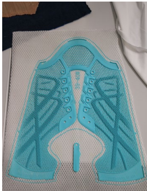
Gewirkter Schuhstoff mit 3D-gedruckter Verstärkungsstruktur © 2022 KARL MAYER
