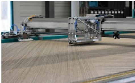
Verarbeitung von Flachfasern auf einer Multiaxial-wirkmaschine © 2022 KARL MAYER
