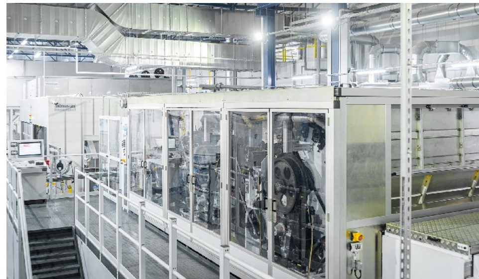
Trützschler Nonwovens 的梳理机 TWF-NCT 适用于人造纤维甚至棉纤维 © 2022 Truetzschler
