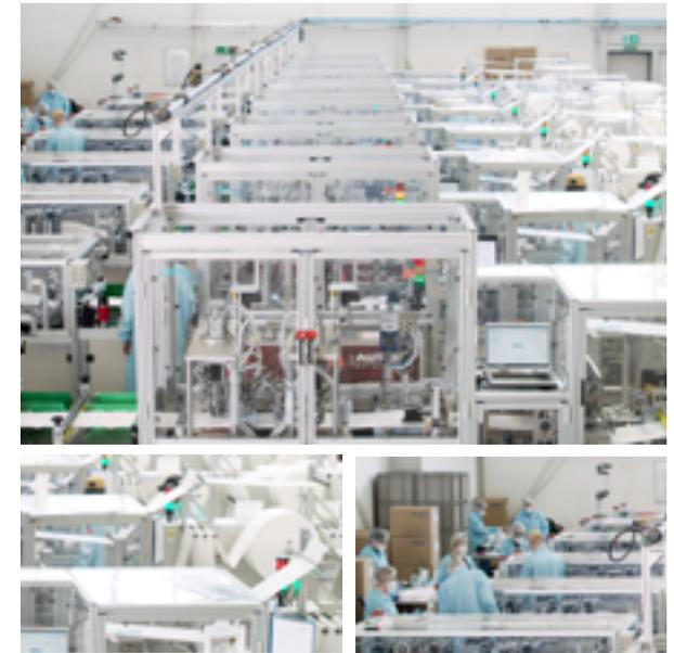
AUTEFA Solutions HiPerMask, eine vollautomatische Produktionslinie für die Herstellung von Schutz-/Gesichtsmasken © 2021 AUTEFA Solutions
