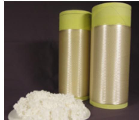
Hanfzellstoff und die daraus nach dem HighPerCell®-Verfahren hergestellten Cellulosefilamente © Photo: DITF
