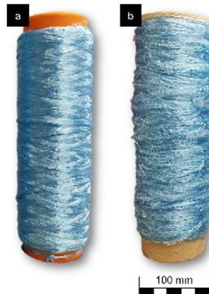
Abbildung 3: glattes PLA-Filament (a) und in Stauchkammer texturiertes PLA-Filament (b) (Quelle: ITA)
