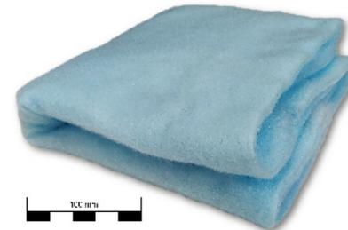
Abbildung 4: Krempelvliesstoff aus PLA-Stapelfasern (Quelle: ITA)
