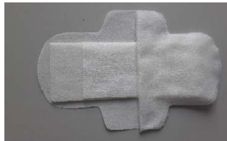
La construcción de telas no tejidas desarrolladas en STFI allana el camino para el uso reutilizable de productos de higiene de base biológica © 2023 STFI
