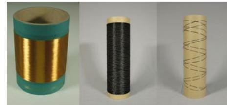
Aus Wasser gesponnene Ligninvorläuferfasern, stabilisierte und karbonisierte Endlosfasern Photo: © DITF
