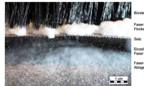
Abbildung 1: Papier Musterherstellung mit Siebbürsten © ITA
