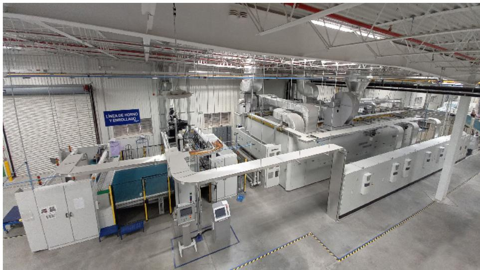
BRÜCKNER 技术中心的贯流带式烘箱/烘干机 © 2023 Brückner
