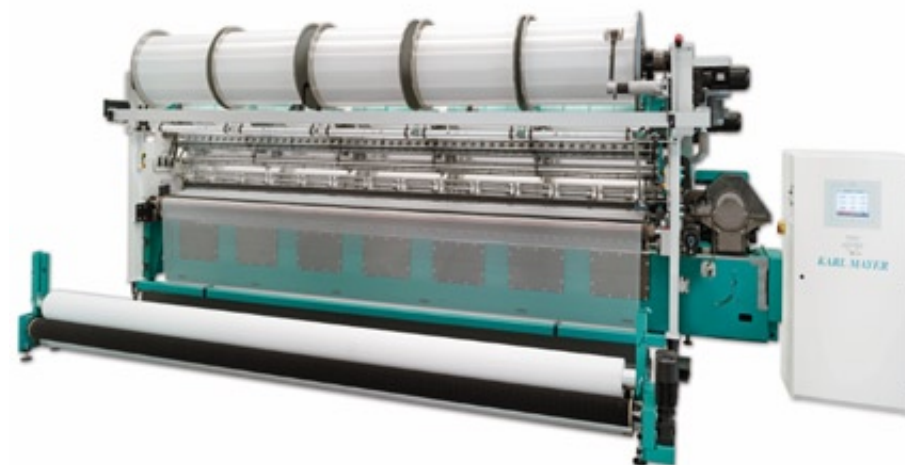
装备了CFRP梳栉的Karl Mayer HKS 3 M机器
