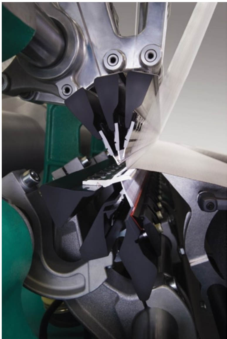
Karl Mayer: 带CFRP梳栉的编织处横截面视图
