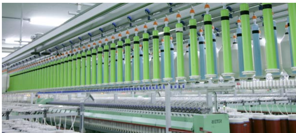
Roving sistemas de transporte de bobinas: Rieter SERVOTrail
