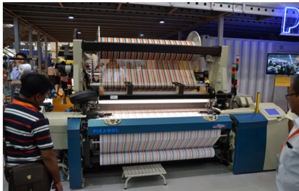
Picanol公司展出正在织造泡泡布的全新剑杆织机GTMax-i 4-R 190。
